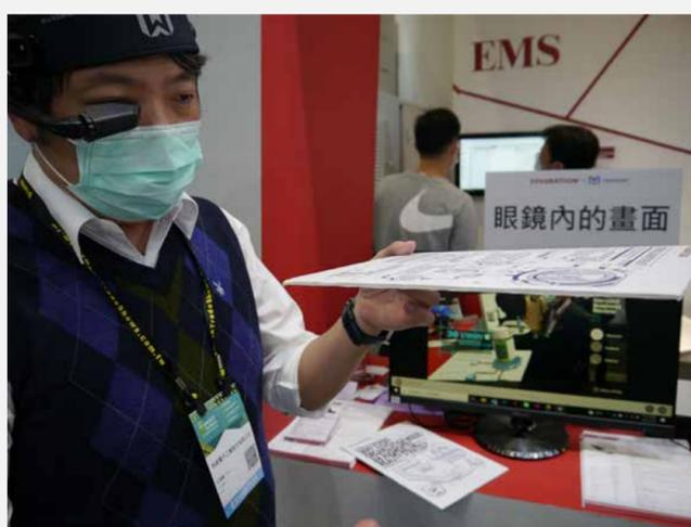
以上市時間較久的 HMT-1 與 HMT-1Z1 而言，本身整合了多種軟硬體。從硬體配置來看，這當中包含麥克風、揚聲器、攝影機、顯示螢幕，以及鋰電池，並且內建了 Wi-Fi 與藍牙等無線網路；而在系統平臺的部分，則是採用 Android OS 10 作業系統，搭配他們開發的穿戴式免手持操作介面層軟體 WearHF（Wear Hands-Free），提供語音與畫面控制的方式。而且在多國語言的介面和語音支援上，HMT-1 與 HMT-1Z1 目前可涵蓋臺灣所用的正體中文等十多種，僅需要簡單的教學即能上手，大大降低使用門檻。
